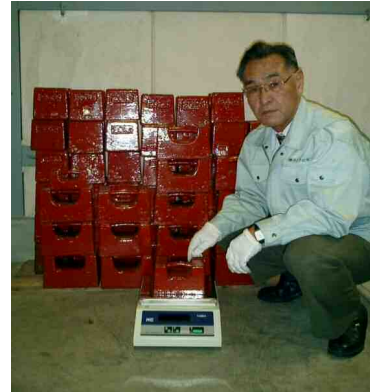
一級基準分銅で分銅校正用マスコンパレーターを当社計量士が校正 当社使用の「実用基準分銅」を校正
