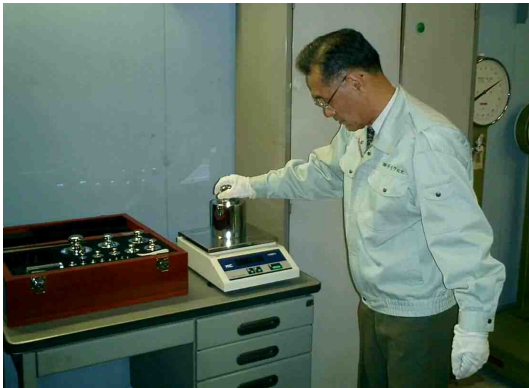
一級基準分銅で分銅校正用マスコンパレーターを当社計量士が校正 当社使用の「実用基準分銅」を校正
